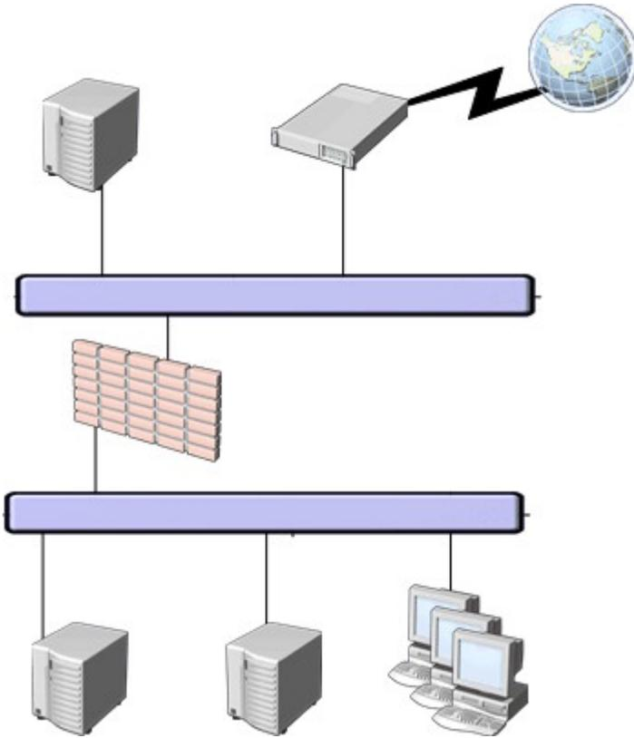
内部网络由一个 Active Directory 域组成。该内部网络包含一台名为 DC1 的 Windows Server 2003 域控制器，该控制器运行 DNS Server 服务。内部网络还包含一台名为 Server1 的 Windows Server 2003 文件服务器，该服务器运行 DHCP Server 服务。公司内部网络包含 500 台 Windows XP Professional 计算机。外部网络包含一个名为 Web1 的公共 Web 服务器。内部网络通过防火墙连接到外部网络。外部网络连接到 Internet。
